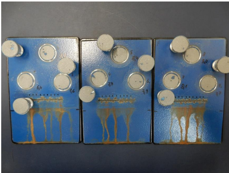
Bild 2: Probenplatten nach zyklischer Alterung
