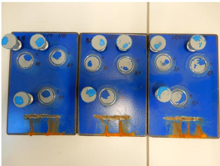
Bild 3: Probenplatten nach 1440 h NSS-Prüfung
