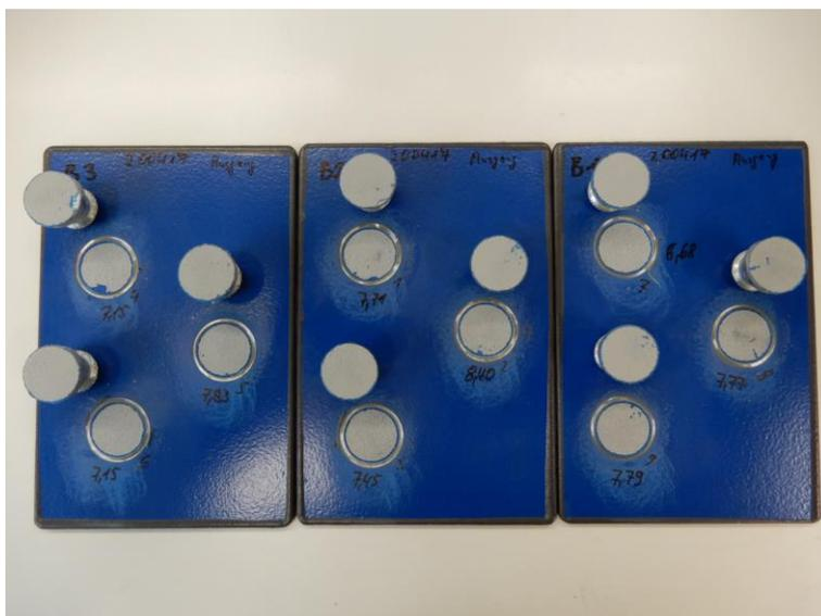
Bild 1: Probenplatten nach Gitterschnittprüfung und Abreißversuch
