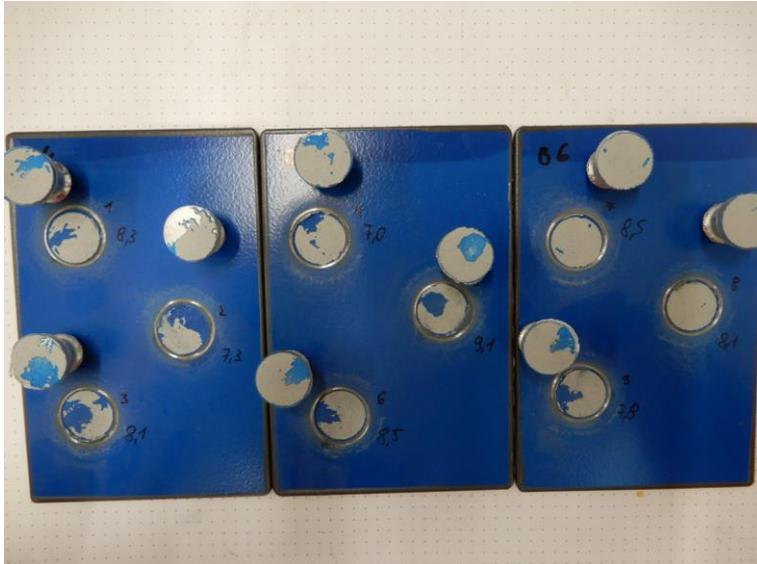
Bild 2: Probenplatten nach 720 h Kondensationsbeanspruchung
